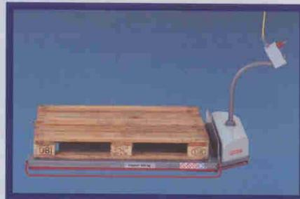
Die Bedientastatur wurde auf eine ergonomisch günstige Höhe gebracht und kann sowohl in der untersten als auch in der angehobenen (750 mm) Stellung des Hubtisches bedient werden.
